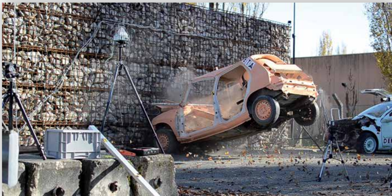
Ensayo de resistencia a un choque con un muro de contención de Tierra Armada® (GeoTrel).
